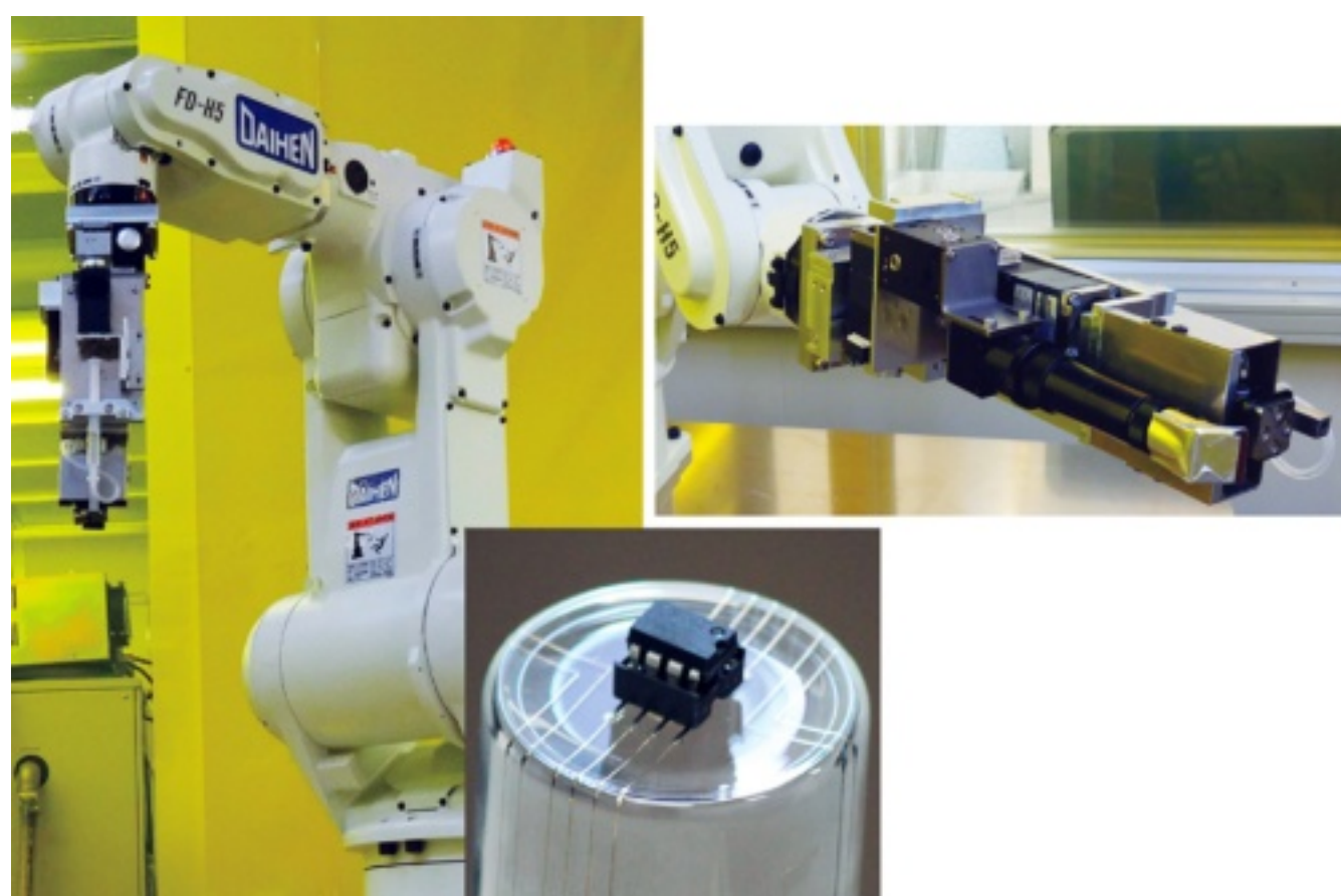
図3 ロボットアームで任意の方向にインクジェット印刷
