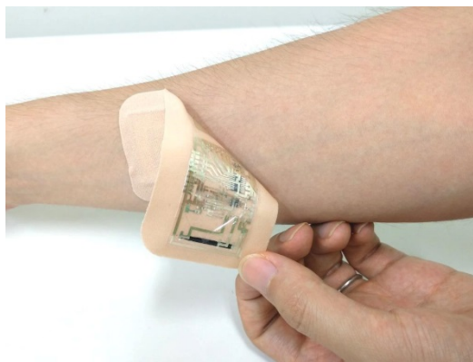
写真 開発段階の絆創膏型無線センサタグ(温度センサタイプ)
