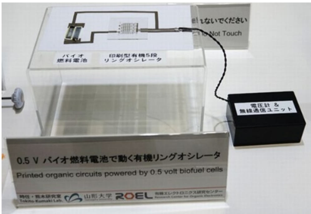
図8 0.5Vバイオ燃料電池で動く有機リングオシレーター 展示ブースで筆者が撮影。
