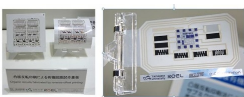
図12 凸版反転印刷法による有機回路試作基板と有機非接触通信タグ 展示ブースで筆者が撮影。
